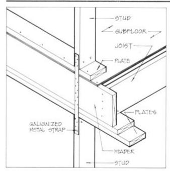
Figure 4.44. Stud-to-Stud Connections
