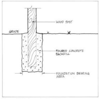
Figure 4.10. Concrete Backfill
